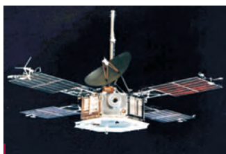
Το Μάρινερ 5 σε πτήση. Τα φωτοβολταϊκά παρέχουν στο σύστημα ενέργεια.
