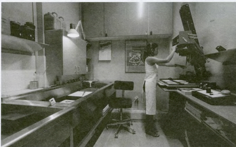
Φωτογραφία 4.1: Σκοτεινός Θάλαμος: υγρό και στεγνό τμήμα στον ίδιο χώρο
