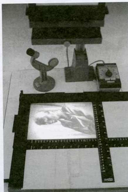
Φωτογραφία 5.9: Καδράρισμα με το πλαίσιο εκτύπωσης
