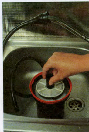
Φωτογραφία 4.24: Αναδεύουμε το καρούλι με το εμφανισμένο φιλμ μέσα στο δοχείο που περιέχει νερό και μερικές σταγόνες υγρού αποσκλήρυνσης
