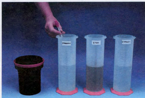
Φωτογραφία 4.17: Έλεγχος θερμοκρασίας της εμφάνισης με το θερμόμετρο οινόπνεύματος
