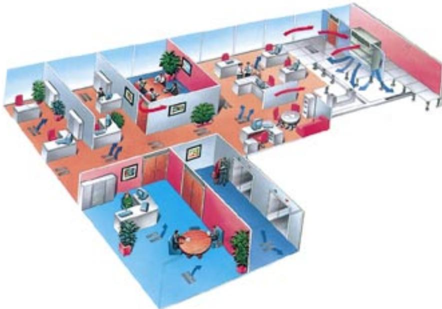
**Σχήμα 8-67:** Κλιματισμός συγκροτήματος γραφείων με μονάδα κλειστού κυκλώματος
