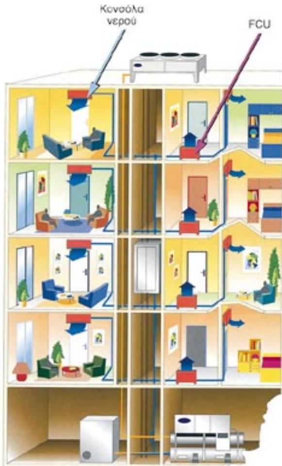
**Σχήμα 9-2:** Διάταξη του συστήματος με τις ΤΚΜ
