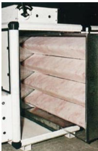
**Σχήμα 8-45:** Φίλτρο KKM, με επιτρεπόμενη ταχύτητα αέρα  $1,5 \text{ m/s}$  και μετωπική στο στοιχείο  $2,5 \text{ m/s}$ . Με τη μορφή αυτή αυξάνεται η συνολική επιφάνεια του φίλτρου, οπότε μειώνεται και η κάθετη συνιστώσα της ταχύτητας πάνω στο φίλτρο.
