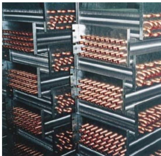
**Σχήμα 7-16:** Από το χώρο αποθήκευσης ημιέτοιμων στοιχείων (δεν έχουν ακόμη τοποθετηθεί οι συλλέκτες), σε ελληνικό εργοστάσιο κατασκευής κλιματιστικών μηχανημάτων
