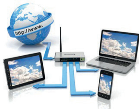
Εικόνα 2.8 Δημιουργία WLAN με Access Point ενσωματωμένο στον οικιακό δρομολογητή
