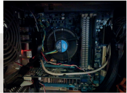
Εικόνα 3.4 Επεξεργαστής ή Κεντρική Μονάδα Επεξεργασίας ή Κ.Μ.Ε μαζί με την ψύκτρα
