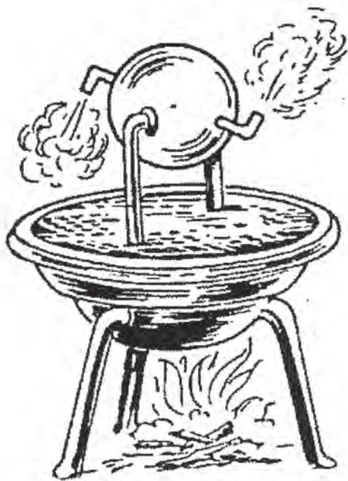
Εικ. 4.1 Σχέδιο του ατμοστρόβιλου που επινόησε ο αρχαίος Έλληνας εφευρέτης Ήρων (Αλεξάνδρεια, περ. 100 μ.Χ.). Το δοχείο είναι κλειστό και επικοινωνεί με τη σφαίρα με τους δύο κατακόρυφους σωλήνες. Με βρασμό νερού παράγεται ατμός στο δοχείο που εισέρχεται από τους σωλήνες στη σφαίρα και εξέρχεται με μεγάλη ταχύτητα από τα δύο ακροφύσια θέτοντας σε περιστροφή τη σφαίρα.
