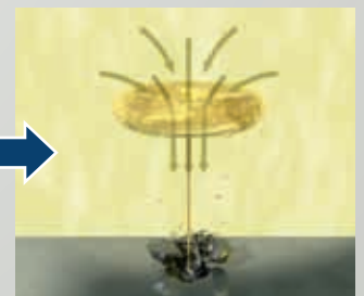
Το micro-jet σπάει από τη φυσαλίδα σπηλαίωσης και πέφτει στην επιφάνεια
