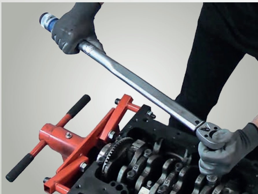
Εικ. 1: Σύσφιξη των βιδών σύμφωνα με τις προδιαγραφές του κατασκευαστή
