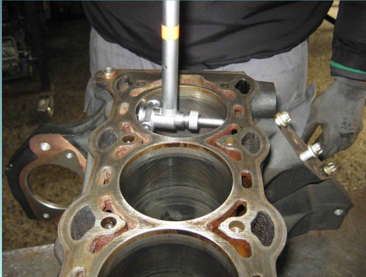
Σχ. 3.19. Τρόπος μέτρησης φθοράς κυλίνδρου.
