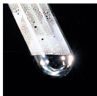
Με θέρμανση το οξείδιο του υδραργύρου (II), \text{HgO} , διασπάται παράγοντας \text{Hg}(\text{l}) και \text{O}_2 .
