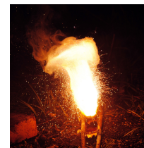
Μία σχετικά εξώθερμη αντίδραση: \text{Fe}_2\text{O}_3 + 2\text{Al} \rightarrow 2\text{Fe} + \text{Al}_2\text{O}_3
