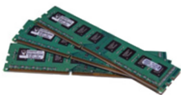
Εικόνα 1.9. Αρθρώματα μνήμης τεχνολογίας DDR
