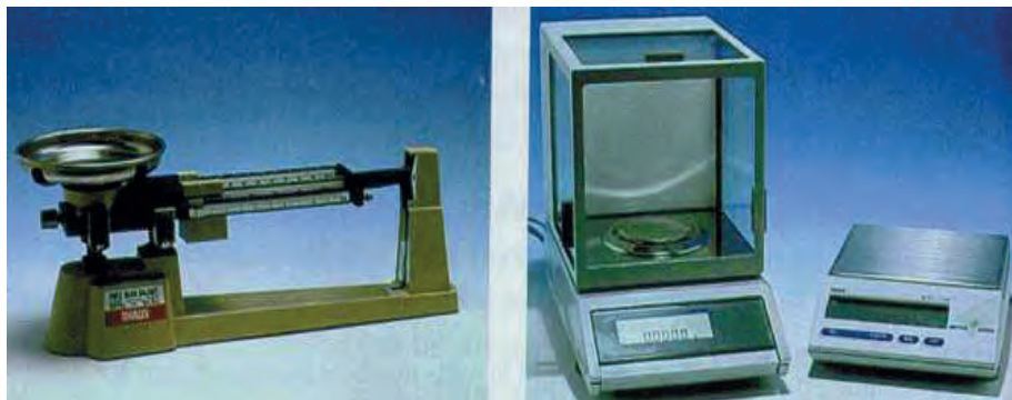
ΣΧΗΜΑ 1.3 Εργαστηριακός ζυγός ενός δίσκου με βερνιέρο και σύγχρονοι ηλεκτρονικοί ζυγοί ακριβείας για τη μέτρηση μάζας.
