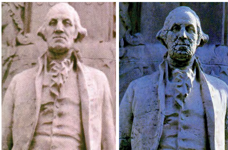
ΣΧΗΜΑ 3.12 Καταστροφή μαρμάρινων μνημείων ιστορικής αξίας. Η όξινη βροχή μετατρέπει το μάρμαρο ( \text{CaCO}_3 ) σε γύψο ( \text{CaSO}_4 \cdot 2\text{H}_2\text{O} ) - γυψοποίηση του μαρμάρου.
