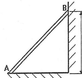
129. Η ομογενής σανίδα AB του σχήματος, έχει μήκος  $\ell$  και μάζα  $m = 20kg$ . Η σανίδα ισορροπεί με την επίδραση δύναμης  $\vec{F}$ , σε θέση τέτοια ώστε το ákro της A να ακουμπά στο οριζόντιο επίπεδο και η γωνία που σχηματίζει μ' αυτό να είναι  $\varphi = 60^\circ$ . Η δύναμη  $\vec{F}$  έχει διεύθυνση κάθετη στη σανίδα. Να υπολογίσετε:
