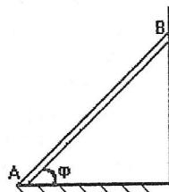
155. Η ομογενής ράβδος  $AB$  του διπλανού σχήματος στηρίζεται στο άκρο  $B$  σε λείο κατακόρυφο τοίχο και στο άκρο της  $A$  σε οριζόντιο δάπεδο. Η γωνία που σχηματίζει η ράβδος με το οριζόντιο επίπεδο είναι  $\varphi$ . Ο συντελεστής οριακής τριβής μεταξύ του άκρου της ράβδου και του δαπέδου είναι  $\mu_{op} = \frac{\sqrt{3}}{6}$ .
