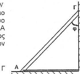
125. Ομογενής δοκός ΑΓ έχει μάζα  $m = 30kg$  και μήκος  $\ell$ . Η δοκός στηρίζεται στο άκρο της Α σε λείο οριζόντιο δάπεδο και στο άκρο της Γ σε λείο κατακόρυφο τοίχο, όπως φαίνεται στο σχήμα. Το άκρο της Α συγκρατείται μέσω αβαρούς οριζόντιου νήματος από τον τοίχο, ώστε η δοκός να σχηματίζει με το οριζόντιο δάπεδο γωνία  $\phi$ . Το κέντρο μάζας της δοκού βρίσκεται σε απόσταση  $\frac{\ell}{3}$  από το άκρο
