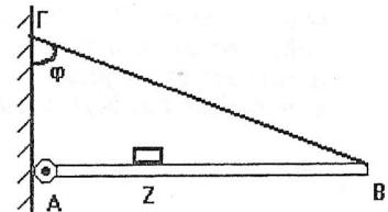
στερεώνεται στο σημείο  $\Gamma$  του τοίχου, μέσω αβαρούς νήματος. Η ράβδος ισορροπεί σε οριζόντια θέση και το νήμα να σχηματίζει γωνία  $\varphi = 60^\circ$  με τη διεύθυνσή της. Το όριο θραύσης του νήματος είναι  $T_{\varphi} = 120N$ . Μικρό σώμα βάρους  $w_1 = 30N$  είναι τοποθετημένο πάνω στη ράβδο στο σημείο  $Z$ , που απέχει από το σημείο  $A$   $x_Z$ . Να υπολογίσετε τη μεγαλύτερη τιμή της απόστασης  $x_Z$ , ώστε το νήμα να μη σπάσει.
