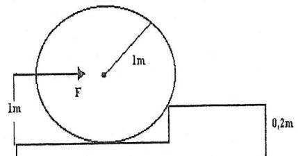
**162.** Ομογενής κύλινδρος έχει μάζα  $m = 2kg$  και ακτίνα  $R$ . Ασκώντας δύναμη  $\vec{F}$  επιδιώκουμε ο κύλινδρος να υπερπηδήσει το σκαλοπάτι, ύψους  $h = \frac{R}{2}$ . Ο άξονας του κυλίνδρου είναι παράλληλος με το οριζόντιο επίπεδο. Η δύναμη  $\vec{F}$  έχει διεύθυνση οριζόντια και ασκείται στο κέντρο μάζας του κυλίνδρου, αλλά έτσι ώστε αυτός να μπορεί ελεύθερα να περιστρέφεται γύρω από άξονα που διέρχεται από τα κέντρα των βάσεων του. Να υπολογίσετε:
