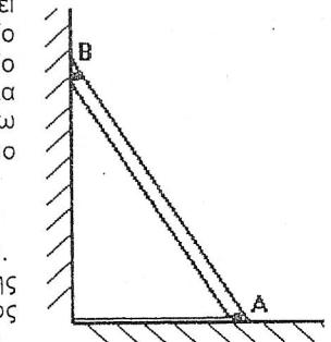
138. Ομογενής σκάλα  $\Gamma\Delta$  μήκους  $\ell = 5m$  και βάρους  $w = 200N$  στηρίζεται σε λείο τοίχο και σε λείο δάπεδο, με τη βοήθεια νήματος  $\Delta\Delta$ , όπως φαίνεται στο σχήμα. Το σχοινί  $\Delta\Delta$  έχει μήκος  $\ell_1 = 3m$  και όριο θραύσης του είναι  $T_{\varphi} = 495N$ . Να υπολογίσετε τη μεγαλύτερη απόσταση που μπορεί να διανύσει ένας άνθρωπος βάρους  $w' = 700N$ , ανεβαίνοντας τη σκάλα, χωρίς να σπάσει το νήμα.
