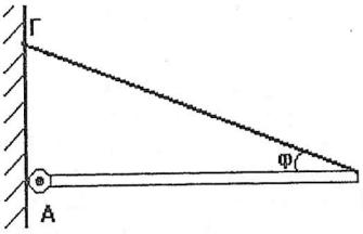
116. Ομογενής δοκός AB βάρους  $w = 80N$  και μήκους  $\ell$  ισορροπεί σε οριζόντια θέση. Το άκρο A της δοκού είναι στερεωμένο σε κατακόρυφο τοίχο μέσω άρθρωσης, γύρω από την οποία μπορεί να στρέφεται, ενώ το άκρο της B στηρίζεται με τη βοήθεια νήματος από τον ίδιο τοίχο, όπως φαίνεται στο σχήμα. Το μέτρο της τάσης του νήματος είναι  $T = 80N$ . Να υπολογίσετε:
