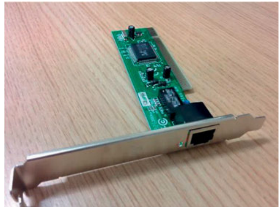
Εικόνα 147: Κάρτα δικτύου ethernet PCI
