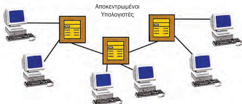
Σχήμα 5.1.10 Δίκτυο αποκεντρωμένης επεξεργασίας
