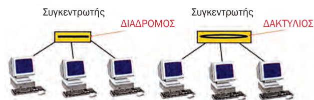
Σχήμα 5.2.10 Τοπολογίες τοπικών δικτύων και καλωδιώσεις
