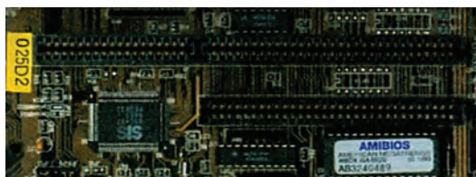
Σχήμα 4.6.1 Υποδοχές επέκτασης ISA 8 bits (κάτω) και 16 bits (πάνω). Στο αριστερό τμήμα της υποδοχής ISA 16 bits υπάρχουν οι επιπλέον γραμμές δεδομένων, διευθύνσεων και ελέγχου.
