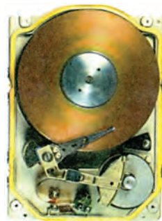
Σχήμα 4.5.2 Ο σκληρός δίσκος είναι ένα μαγνητικό μέσο αποθήκευσης πολύ μεγάλης χωρητικότητας που χρησιμοποιείται στους προσωπικούς υπολογιστές ως βοηθητική μνήμη.
