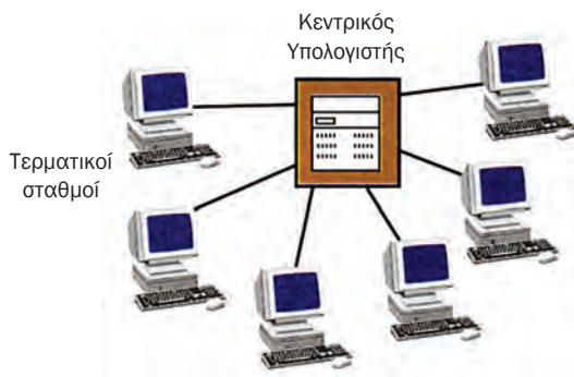
Σχήμα 5.1.8 Δίκτυο συγκεντρωμένης επεξεργασίας
