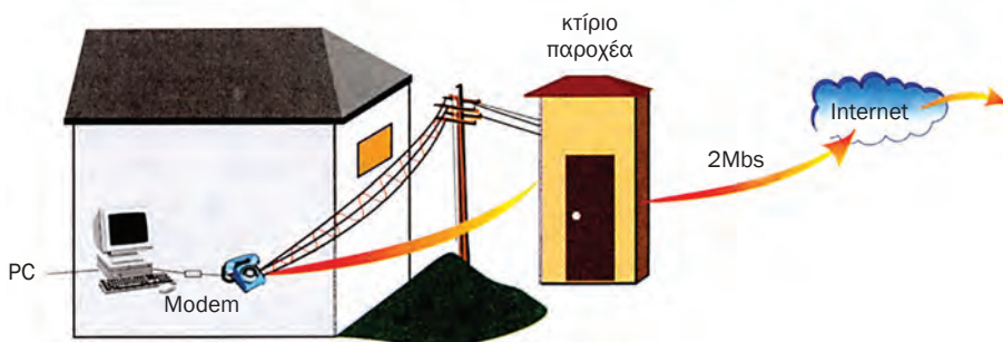
Σχήμα 5.3.4 Τα modem χρειάζονται για να συνδεθούν υπολογιστές μεταξύ τους χρησιμοποιώντας το τηλεφωνικό δίκτυο.
