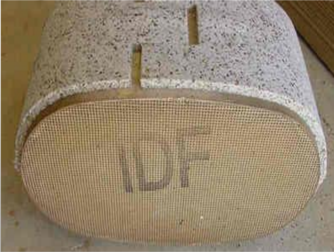
Σχ. 14.9. Τριοδικός καταλύτης με τετραγωνικής μορφής κανάλια (OPEL).
