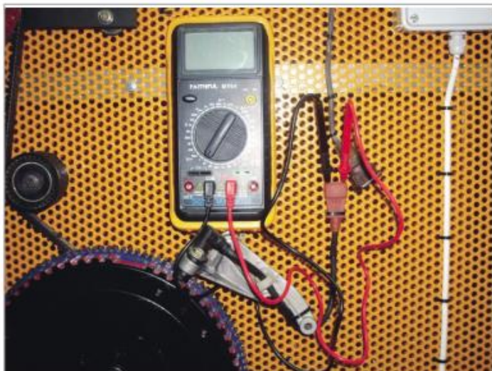
Μέτρηση της τάσης του επαγωγικού αισθητήρα στροφών.
