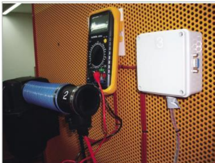
Μέτρηση της τάσης (σήμα) του αισθητήρα μάζας.
