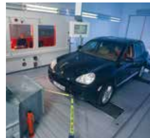
Οι ιδιότητες ψυχρής εκκίνησης από τα μπουζί εξετάζονται βάσει του φορητού ελέγχου δύο αξόνων της BERU στο Ludwigsburg στο Κέντρο Έρευνας & Ανάπτυξης.
