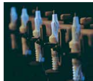
Δοκιμές μονωτών σε 40.000 volt: Τα μπουζί BERU πρέπει να αποδεικνύουν την αξιοπιστία τους στα ειδικά μηχανήματα δοκιμής, να γίνουν αποδεκτά και κατόπιν να ξεκινήσει η σειρά παραγωγής τους.
