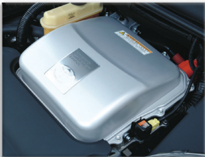
Εικόνα 7.14: Η μονάδα ελέγχου ισχύος.
