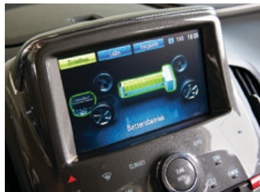
Εικόνα 4.18: Πίνακας ενδείξεων ηλεκτρικής κίνησης.
