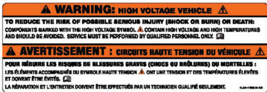
Εικόνα 8.2: Αυτοκόλλητη προειδοποίηση κινδύνου υψηλής τάσης.
