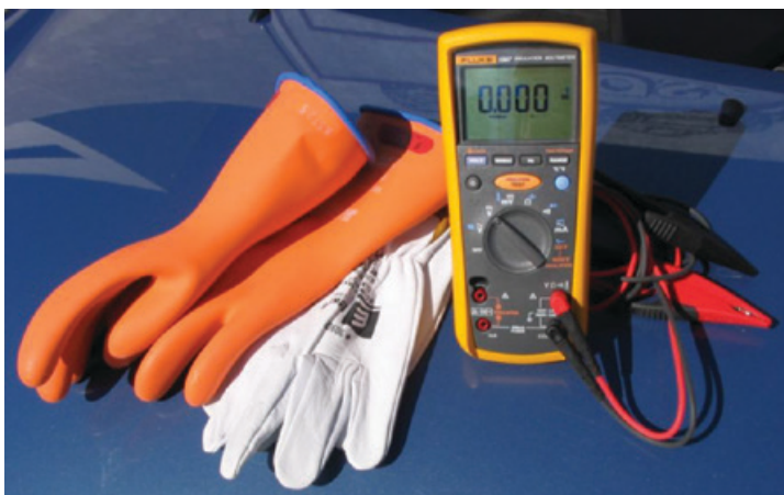
Εικόνα 10.9: Γάντια για εργασίες σε συστήματα υψηλής τάσης υβριδικών οχημάτων.
