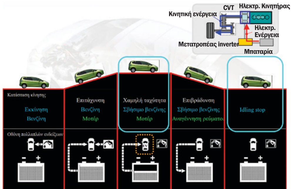
Σχήμα 7.8: Η κίνηση μόνο με ρεύμα (EV) και το idle stop έχουν βελτιωθεί ως λειτουργίες.
