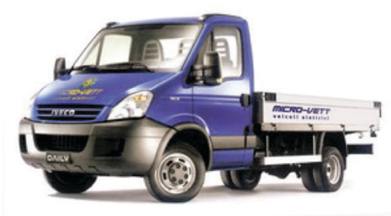
Εικόνα 1.10: Υβριδικό πετρελαιοκίνητο-ηλεκτροκίνητο μικρό φορτηγό.
