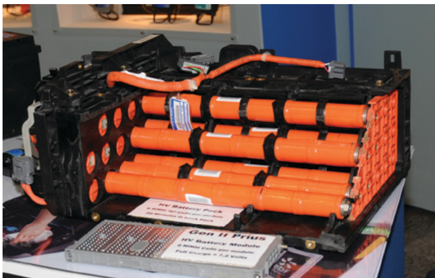
Εικόνα 5.3: Συστοιχία μπαταριών Ni-MH. Σε κάθε συστοιχία (πορτοκαλί σωλήνα) βρίσκονται 6 στοιχεία και συνολικά το σύστημα αποτελείται από 20 συστοιχίες.
