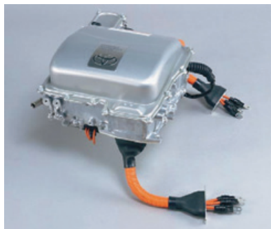
Εικόνα 5.8: Ηλεκτρονική μονάδα διαχείρισης υψηλής τάσης (HV – High Voltage) σε Toyota. Το χρώμα των καλωδίων είναι πορτοκαλί.
