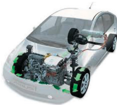
Σχήμα 6.8: Κανονική οδήγηση (κινητήρας και ηλεκτρικά). Ενώ ο κινητήρας κινεί τους τροχούς μέσω των πλανητικών γραναζιών, ο MG1 κινείται μέσω των πλανητικών γραναζιών για την παροχή ηλεκτρισμού στον MG2.
