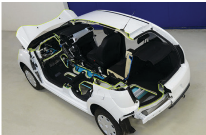
Σχήμα 2.5: Τομή αμαξώματος Citroën C3 Hybrid Air. Διακρίνεται το σύστημα ανάκτησης ενέργειας.
