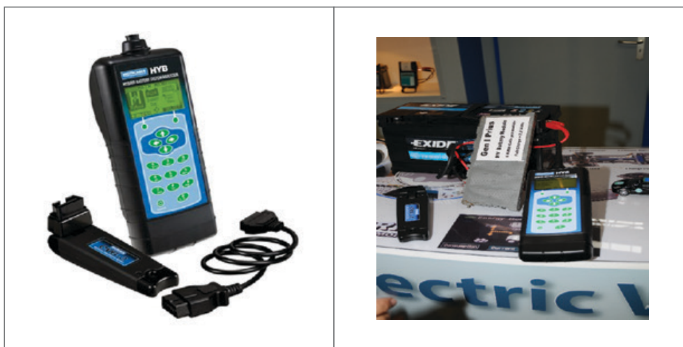
Εικόνες 10.6: Συσκευή ανάλυσης της κατάστασης υβριδικής μπαταρίας.
