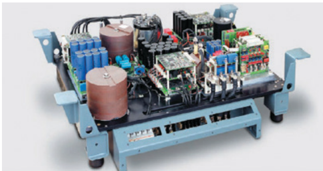
Σχήμα 3.9β: Μετατροπέας DC/DC σε τρόλεϊ.
