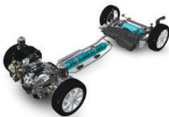
Σχήμα 2.6: Το Hybrid-Air σύστημα της γαλλικής εταιρείας αυτοκινητοβιομηχανίας PSA (Citroën-Peugeot automobile group) ενσωματώνει κατά μήκος του πλαισίου του αυτοκινήτου
