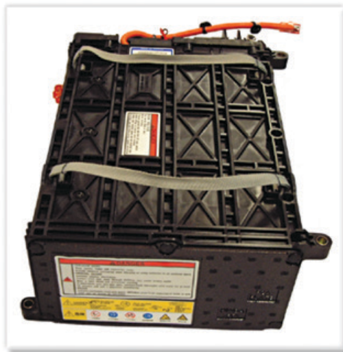
Εικόνα 7.2: Η ηλεκτρική ενέργεια αποθηκεύεται στο σύστημα μπαταριών IMA στην πλάτη των καθισμάτων.
