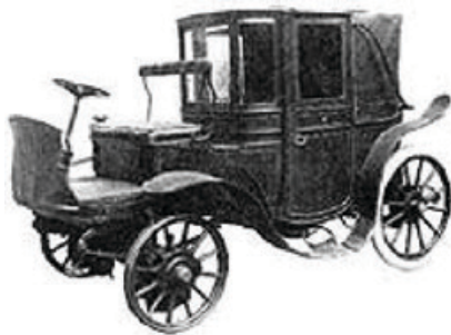
Εικόνα 1.2: Αυτοκίνητο που κατασκευάστηκε από την εταιρεία Krieger το 1903 και χρησιμοποιούσε έναν βενζινοκίνητηρα για να υποστηρίξει μία συστοιχία μπαταριών.
