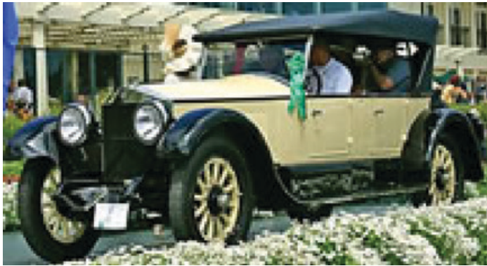
Εικόνα 1.3: Το Owen Magnetic Model 60 Touring του 1921 χρησιμοποιεί έναν βενζινοκινητήρα για να κινεί μία γεννήτρια, η οποία παρέχει ηλεκτρικό ρεύμα σε μοτέρ που βρίσκονται τοποθετημένα μέσα στον καθένα από τους πίσω τροχούς.
