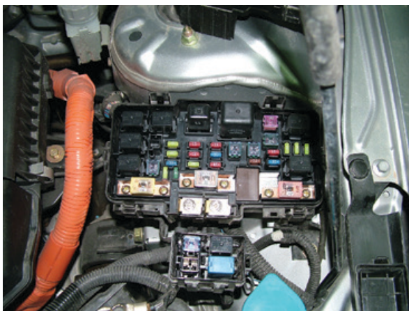
Εικόνα 5.9: Καλωδίωση υψηλής τάσης σε HONDA IMA με πορτοκαλί χρώμα.
