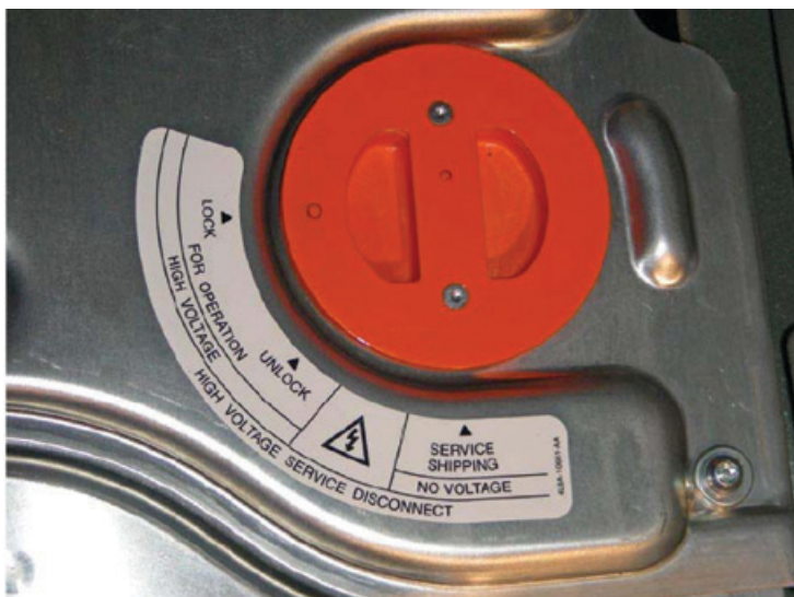
Εικόνα 8.5: Διακόπτης ελέγχου υψηλής τάσης σε υβριδικό όχημα FORD ESCAPE HYBRID
