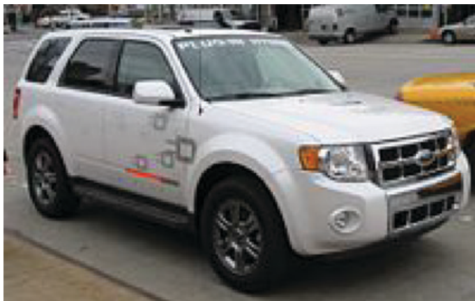
Εικόνα 4.2: Το υβριδικό Ford Escape με πρίζα plug-in.
