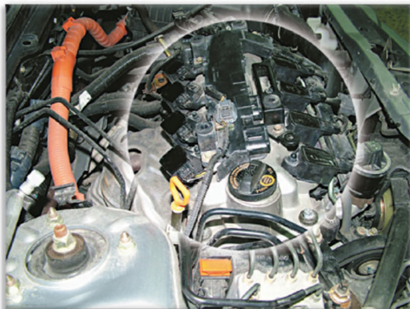
Εικόνα 7.4: Οκτώ μονάδες ανάφλεξης στον κινητήρα. Σύστημα μεταβλητού χρονισμού βαλβίδων βενζινοκινητήρα.
