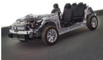
Εικόνα 2.8: Το νέο πλαίσιο της PSA με την ονομασία EMP2 είναι σημαντικά ελαφρύ και παραμετροποιήσιμο σε αρκετές εφαρμογές. Η General Motors (συνέταιρος της PSA) ίσως να καταλήξει στη χρήση αυτής της αρχιτεκτονικής.
