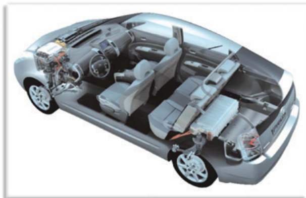
Σχήμα 7.12: Ο χώρος του κινητήρα, του ηλεκτροκινητήρα και των μπαταριών δεν εμποδίζουν καθόλου την ευρυχωρία του αυτοκινήτου.
